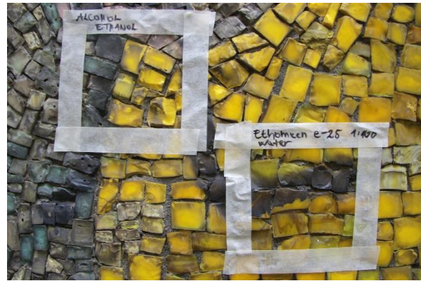
Obr. 25: Zkoušky čištění mozaiky v Praze-Vršovicích. Zkouška čištění pomocí technického lihu a detergentu Ethomeen C-25 s vodou v objemovém poměru 1 : 100.
