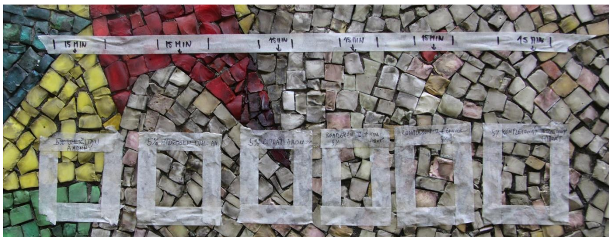
Obr. 29: Zkoušky čištění mozaiky v Praze-Vršovicích. Zkoušky čištění pomocí chelatačních činidel: 5% (hm.) uhličitán amonný, 5% (hm.) hydrogenuhličitán amonný, 5% (hm.) citrát amonný, 5% (hm.) Komplexon III (disodná sůl kyseliny ethylendiamintetraoctové) upravený hydroxidem sodným na pH 7, Komplexon II (kyselina ethylendiamintetraoctová, EDTA) upravený čpavkovou vodou na pH 7 (nasycený roztok) a 5% (hm.) Komplexonát tetrasodný hydrát (tetrasodná sůl kyseliny ethylendiamintetraoctové). Testované 5% roztoky byly aplikovány na vatovém smotku (spodní řada zkoušek) a v zábalu z papíroviny Arboce BC 200 na 15 min (horní řada zkoušek).
