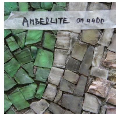
Obr. 28: Zkoušky čištění mozaiky v Praze-Vršovicích. Zkoušky čištění pomocí kationových iontoměničů: Purolite C-100H a Amberlite IR120H a anionového iontoměniče Amberlite OH 4400. Doba působení 10 min.
