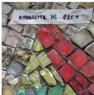
Obr. 28: Zkoušky čištění mozaiky v Praze-Vršovicích. Zkoušky čištění pomocí kationových iontoměničů: Purolite C-100H a Amberlite IR120H a anionového iontoměniče Amberlite OH 4400. Doba působení 10 min.
